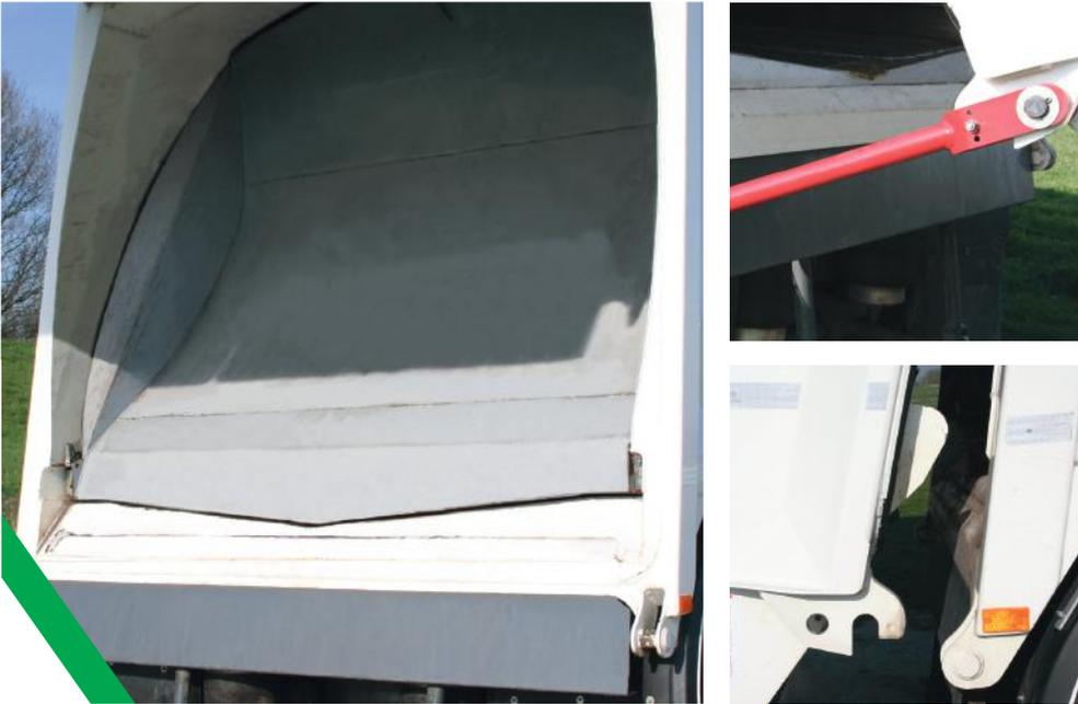
Der Abfallsammelaufbau hat eine kielförmige Bodengruppe mit seitlichen Führungen für das Ausstoßschild. Dies ermöglicht bei der Entleerung, die mittige Abfuhr von Flüssigkeiten.
