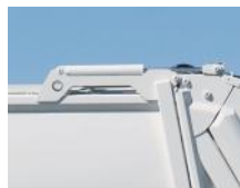
4 Heckteilzylinder auf den Dach
