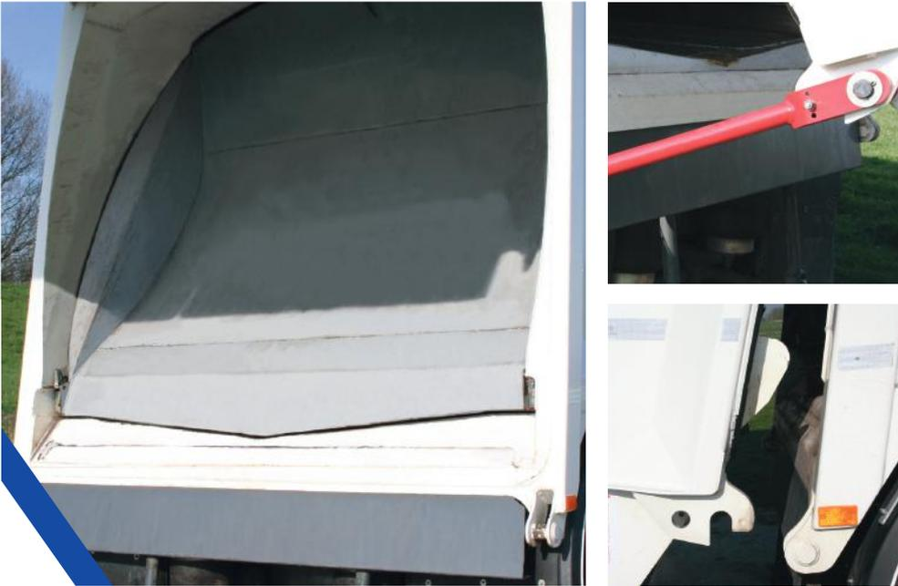
Der Hecklader verfügt über einen kiefelförmigen Boden, wodurch eine sehr gute Stabilität erreicht wird.
