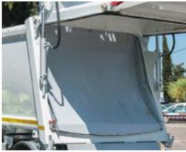
**1** An den Aufbau angepasstes Ausstoßschild
