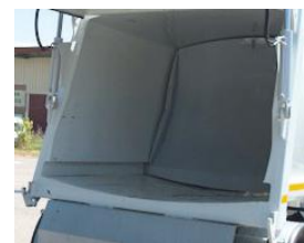
2 Glattflächige Seitenwände Kiefförmige Bodengruppe mit seitlichen Führungen für das Ausstoßschild.
