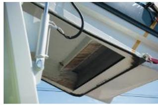
**3** Dichtung zwischen Aufbau und Heckteil bis zur Maximalhöhe
