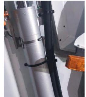
**5** Außenliegende Trägerplattenzylinder
