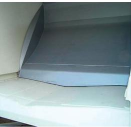
2 Kielförmige Bodenplatte mit seitlichen Führungen für das Ausstoßschild
