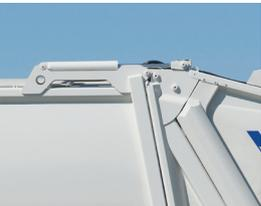
4 Heckteilzylinder auf den Dach
