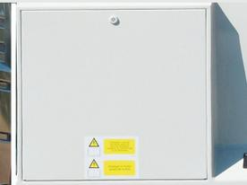
9 Zentrale und leicht zugängliche Aufbauelektronik innerhalb eines wasserdichten Kastens
