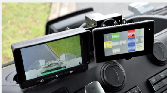
Für alle ROTOLYMPUS Aufbauten wird ein 5-Zoll Multifunktions-Touch-Display im Fahrerhaus montiert, über das sämtliche Arbeitsschritte und Aufbaubedienungen einfach durchzuführen sind.
